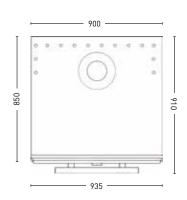
vent outlet: 4,72 Ø firebreak: 5,90 Ø
