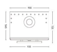
vent outlet: 4,72 Ø firebreak: 5,90 Ø
