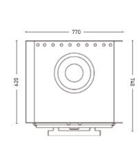
vent outlet: 4,72 Ø firebreak: 5,90 Ø
