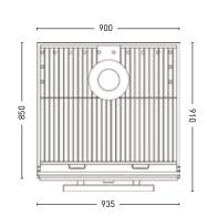
vent outlet: 4,72 Ø firebreak: 5,90 Ø
